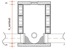
**Corte Genérico Caixa de Esgoto**
